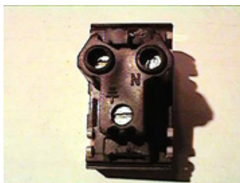
Vista trasera del mismo módulo que muestra el correcto conexionado de los conductores de línea, neutro y tierra
