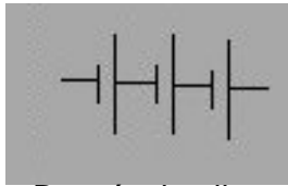
Batería de pilas
